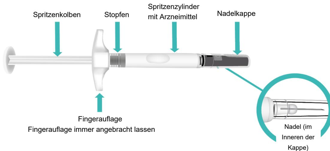
Abbildung A: TAKHZYRO-Fertigspritze
